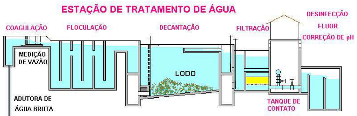
Figura 3: Esquemática das etapas utilizadas na ETA de Iporá para o tratamento de água. Fonte: ROSCHILD, 2018, p.9
