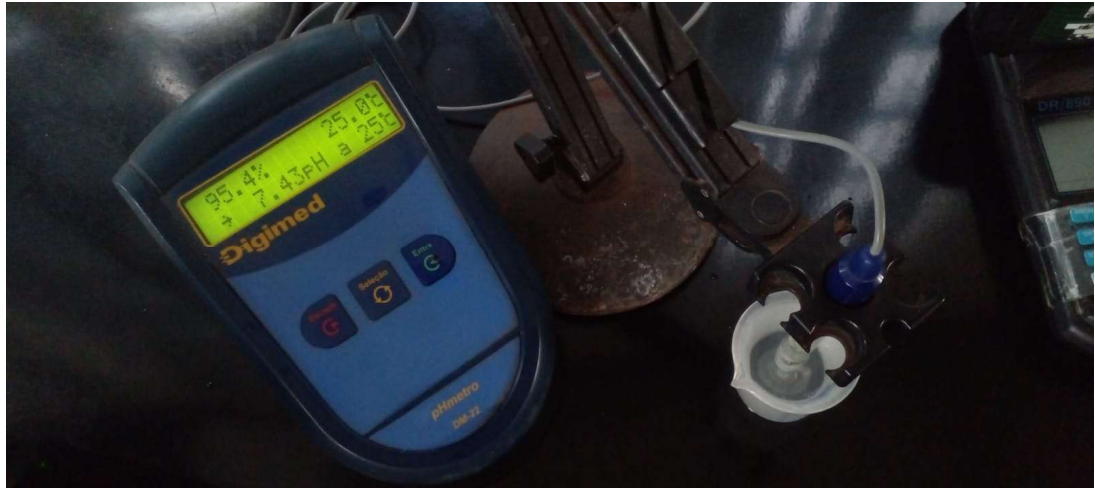
Figura 5: Foto do pHmetro usado para medição do pH das amostras coletadas. Fonte: Própria, 2022.
