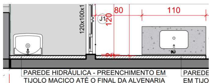
Figura 4 – Detalhamento da parede hidráulica na área de serviço e cozinha.
